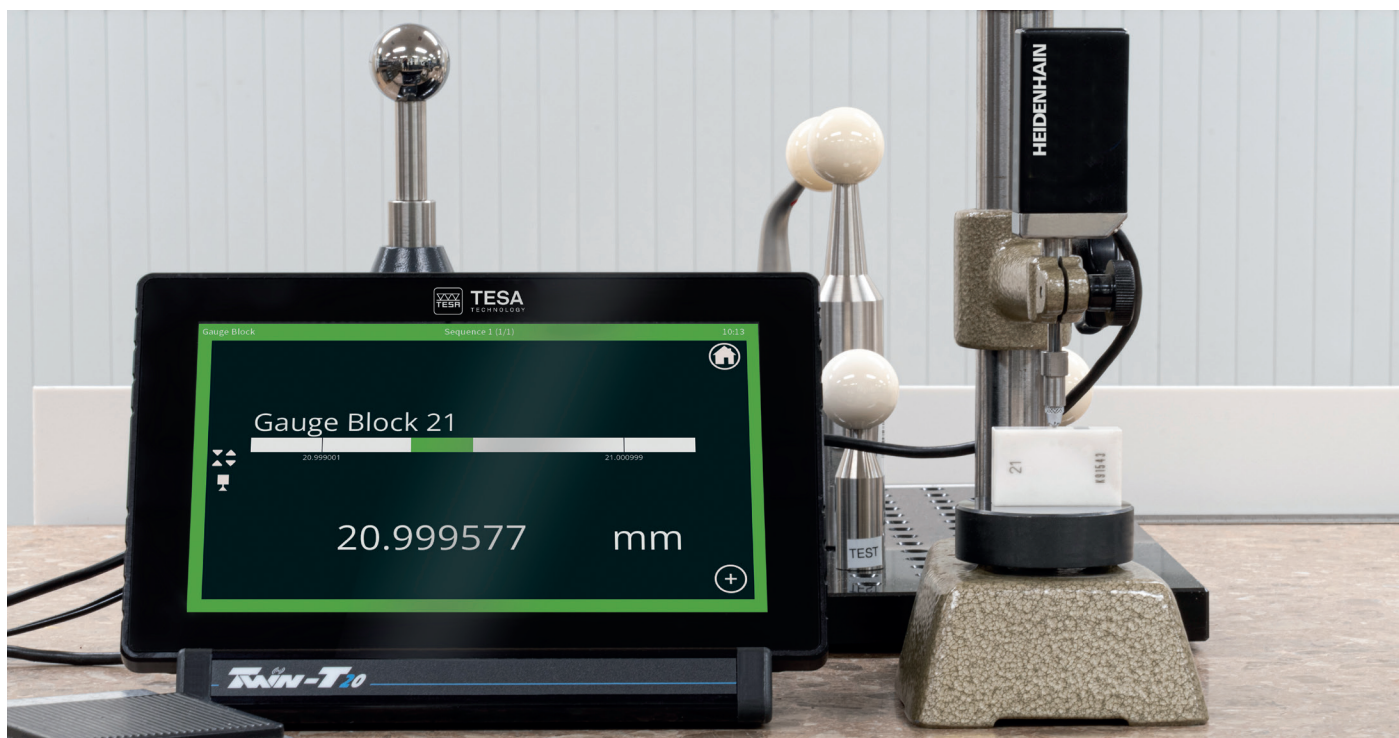
Contrôle d'une cale étalon en céramique
