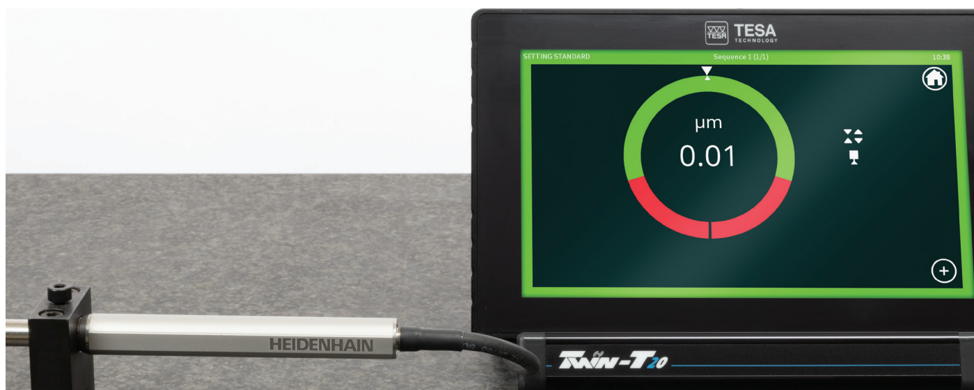
Mesure comparative intuitive avec l'affichage type «Indicateurs tournants»
