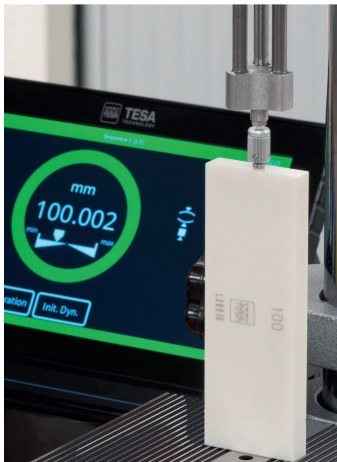
Contrôle d'une cale étalon en céramique
